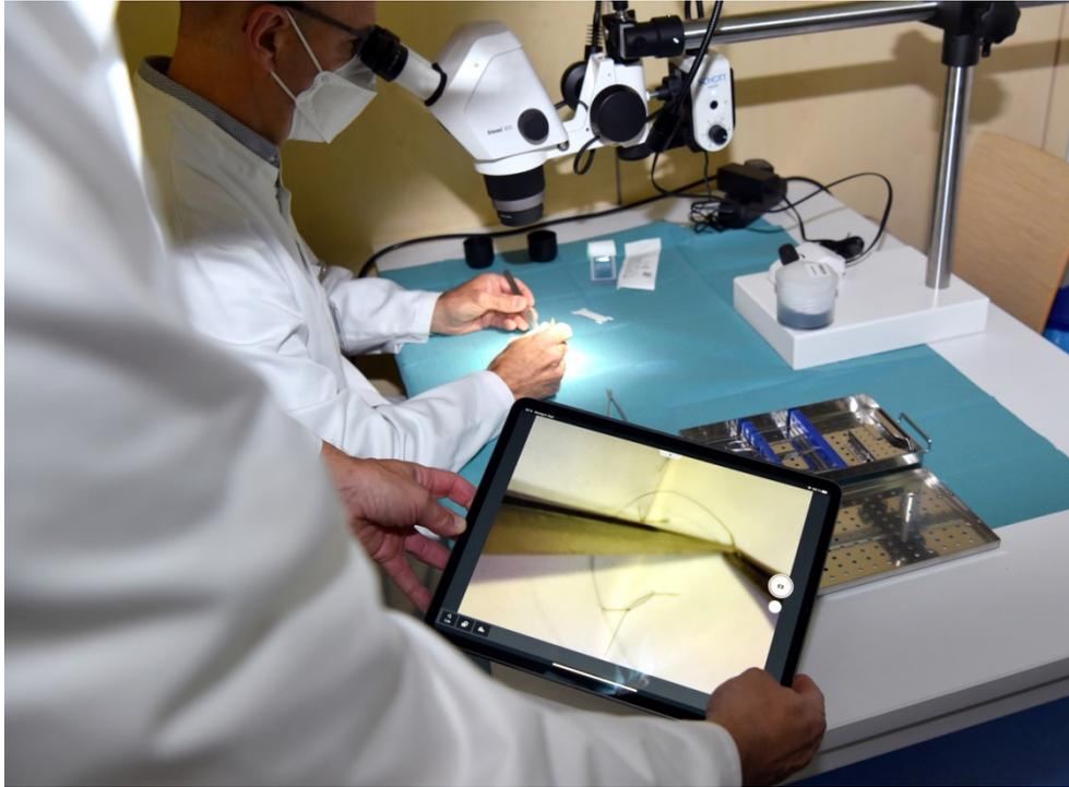
Jedes OP-Mikroskop hat eine WiFi-Kamera integriert, sodass das Arbeitsergebnis auf dem Tablet begutachtet oder auf der Leinwand diskutiert werden kann.
