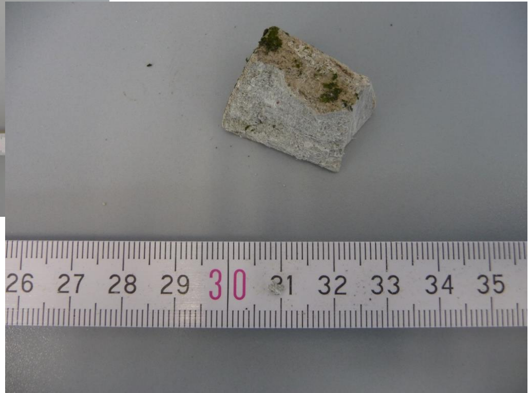
Dachverkleidung (Asbest)
