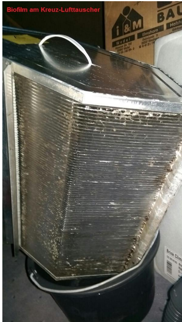
Biofilm am Kreuz-Lufttauscher
