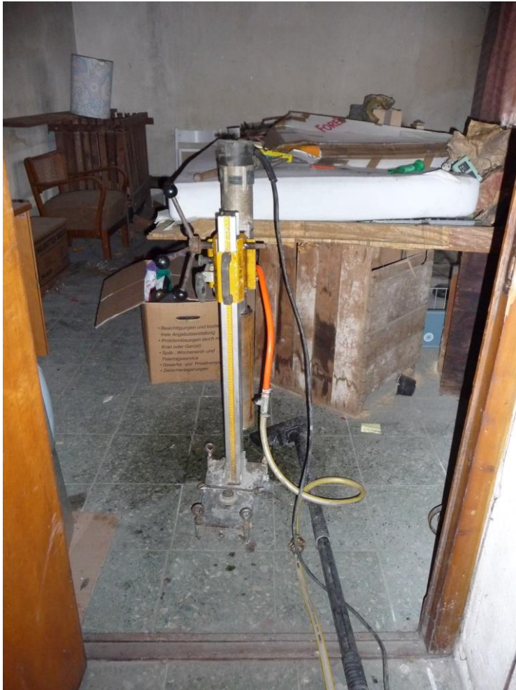
Entnahme eines Bohrkerns
